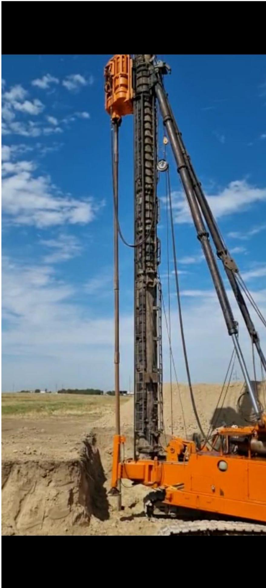
3. Буровая установка Casagrande B180 HD. Шнековое бурение, бурение с применением обсадных труб, бурение свай методом раскатки. Диаметры бурения от 400 до 1500 мм, глубина бурения до 48 метров
