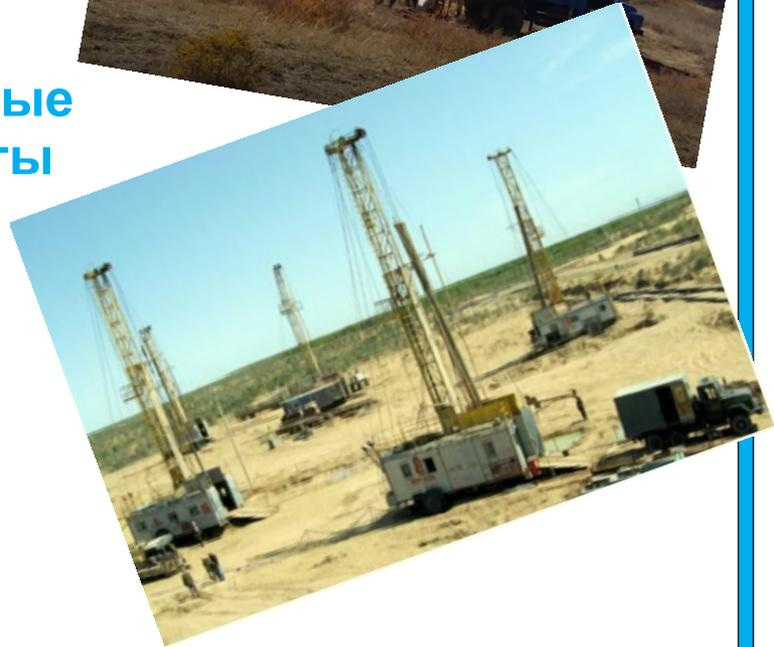
**Ударно-канатный** - бурение скважин малого и большого диаметра в породах любой твердости. Удаление продуктов разрушения механическим способом с помощью желонки, получение продуктов разрушения в виде шлама и керна, в зависимости от вида и физических свойств грунтов. Стенки, как правило, закрепляются обсадными трубами.
