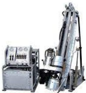
Установка для алмазного колонкового бурения
